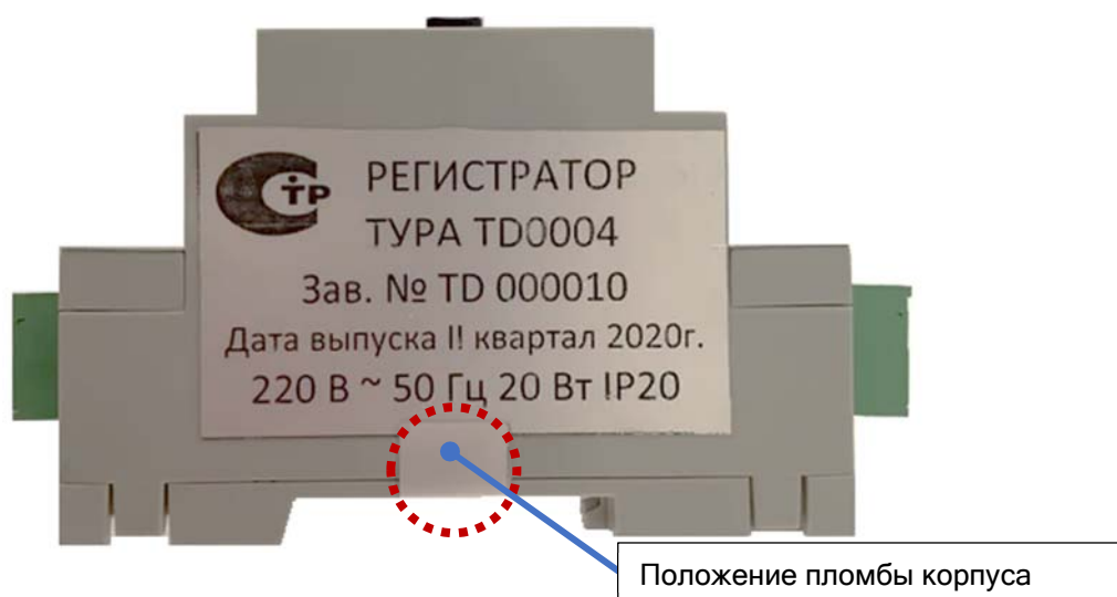
Рис. А.2 Расположение идентификационной таблички и пломб прибора
